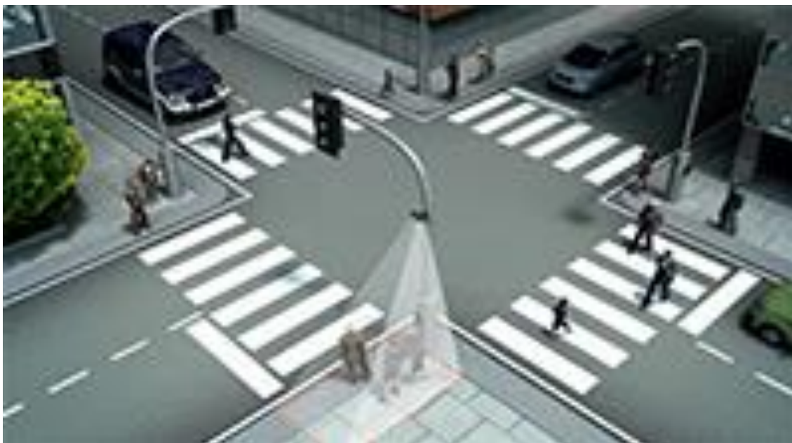
Рисунок 41. Обнаружение пешеходов оптическим датчиком и активация предупредительной световой сигнализации
