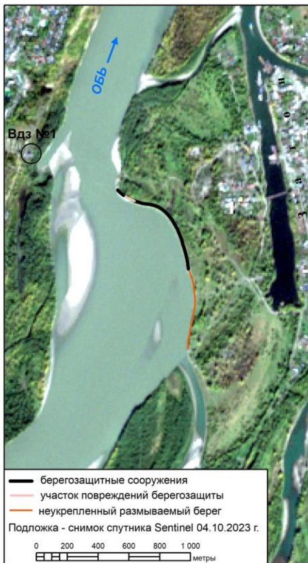
Рисунок 18. Негативные тенденции русловых переформирований р. Обь на территории г. Барнаула. Участок русла в районе городского водозабора №1. Фото 1 – поврежденный участок берегозащитного сооружения. На заднем плане – земснаряд, расчищающий подходной канал к ковшу водозабора. Фото 2 – фрагмент поврежденного участка берегозащитного сооружения. Фото 3 – неукрепленный, размываемый берег у верхнего фланга берегозащитного сооружения
