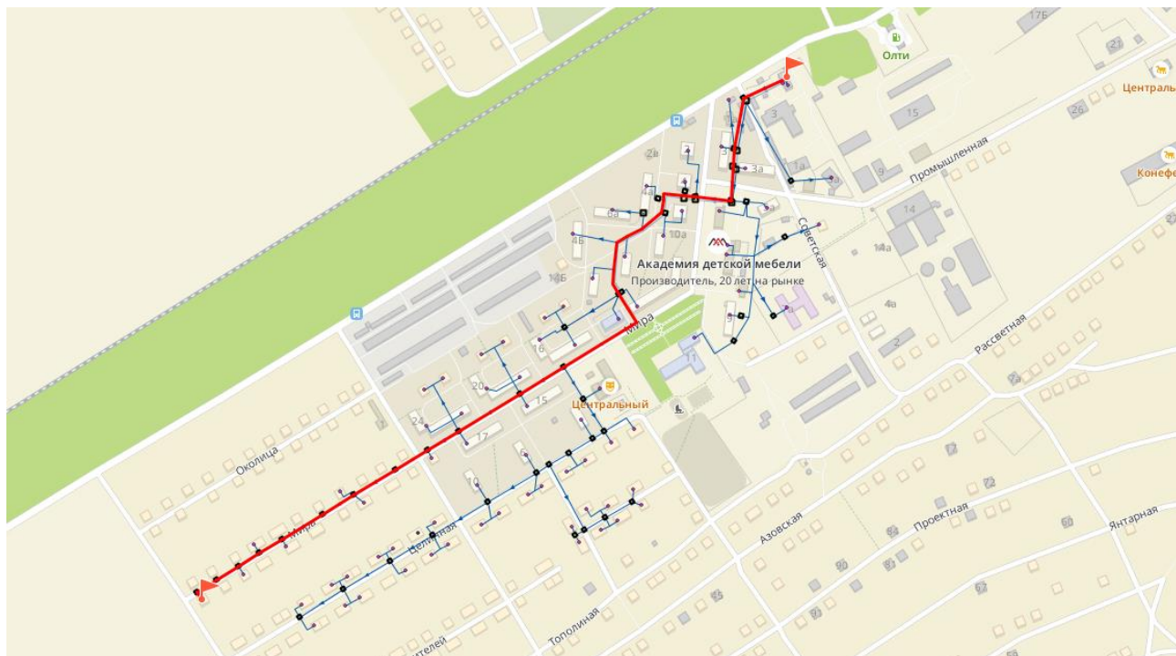
Рисунок 2.33 - Путь теплоносителя по направлению от котельной по улице Промышленная, 3 до потребителя «ул. Мира, 37»
