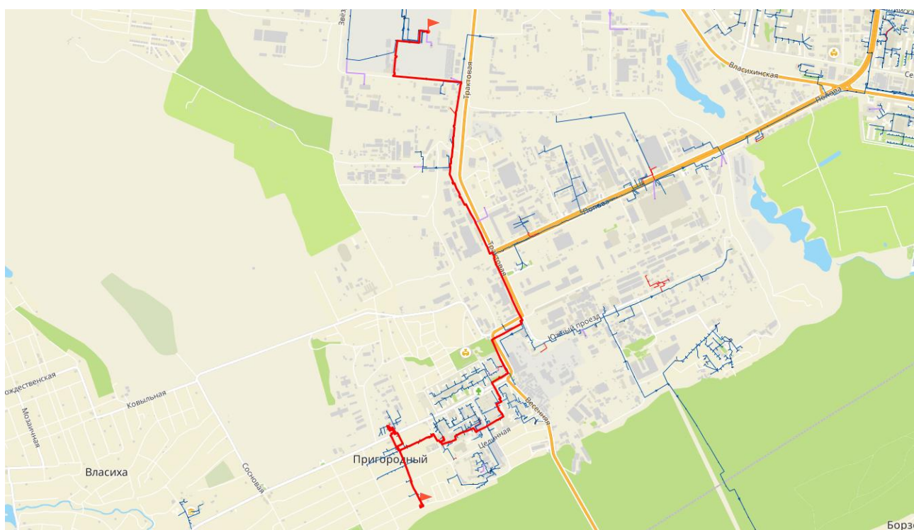
Рисунок 2.9 - Путь теплоносителя по направлению от ТЭЦ-3 до потребителя «ул.Боровая, 42»
