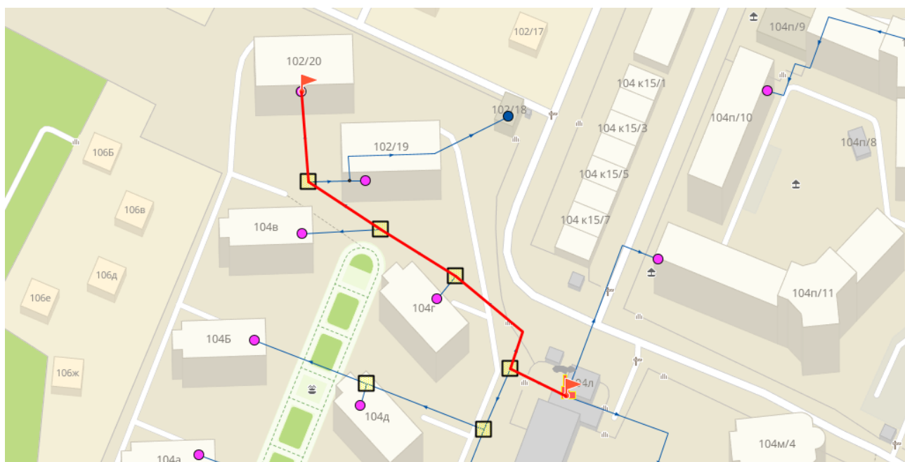
Рисунок 2.97 - Путь теплоносителя по направлению от котельной ООО «Затан» до потребителя «Змеиногорский тр., 102/20»
