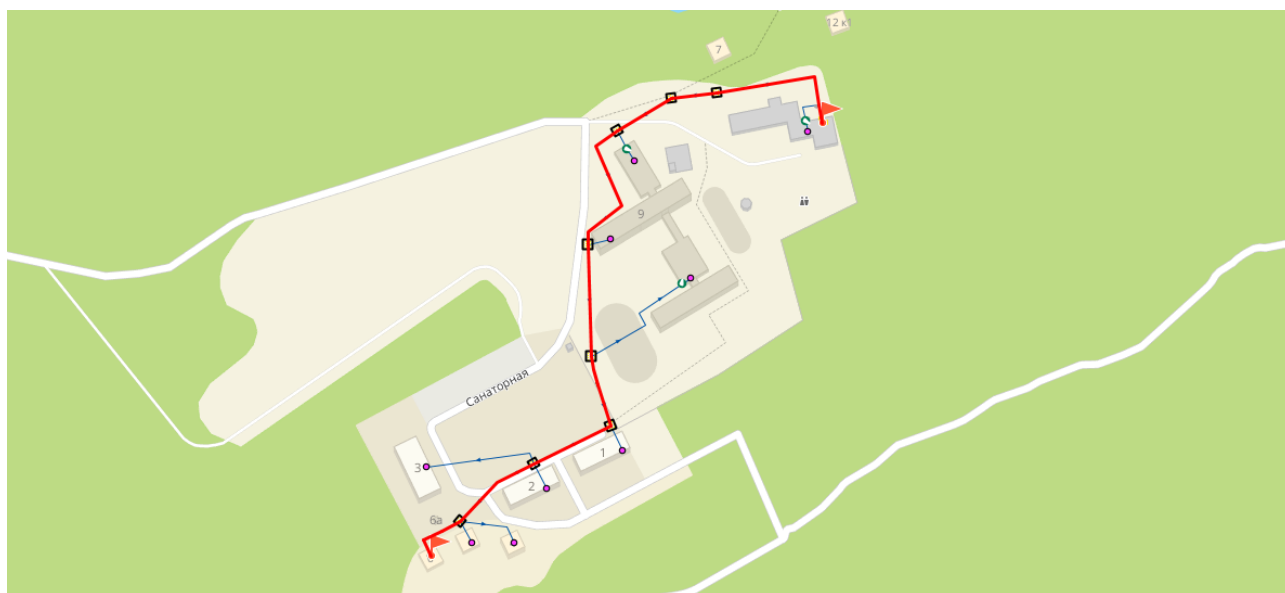
Рисунок 2.75 - Путь теплоносителя по направлению от котельной по ул. Санаторная, 9 до потребителя «ул. Санаторная, 6»
