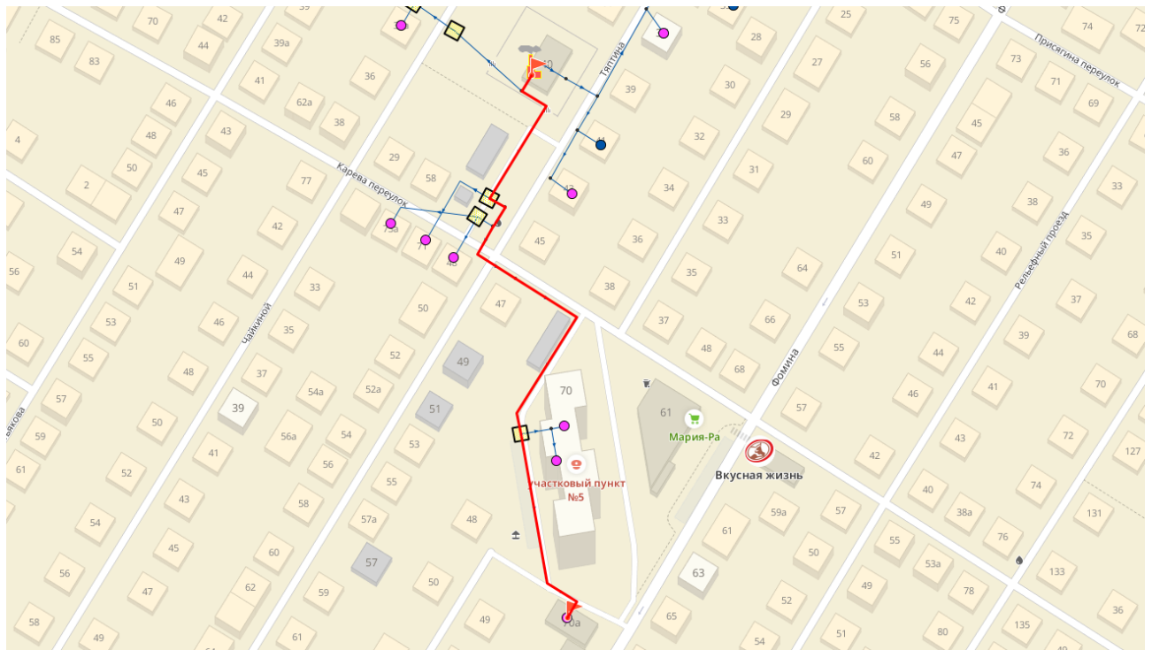
Рисунок 2.23 - Путь теплоносителя по направлению от котельной по улице Тяпина, 40 до потребителя «ул. Фомина, 70а»
