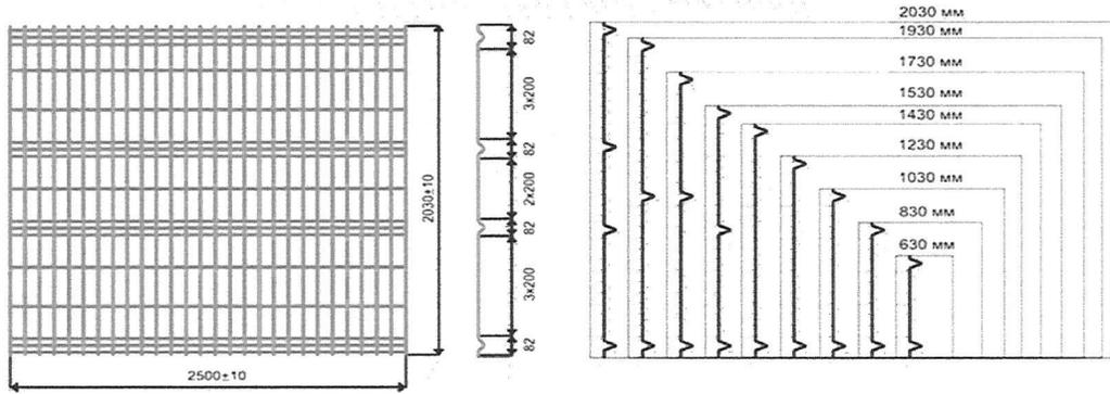
Высота панели от 630\*2500 до 2830x2500 диаметр прутка 3,7мм, 4мм, 5 мм, 6мм, ячейка 55\*200,
