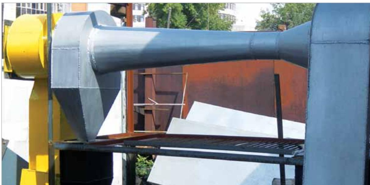
*Опытный образец пылеуловителя готовится к промышленным испытаниям*
