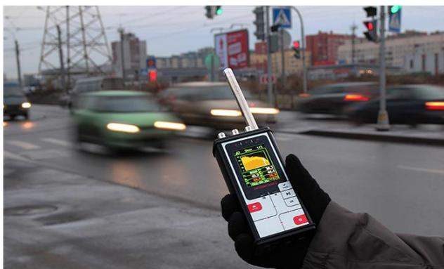
*Рисунок 78 - Измерение шума*
